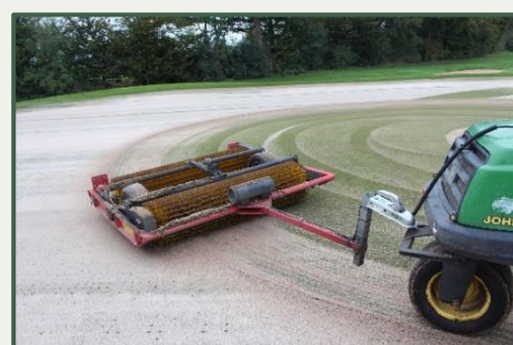
Finalisierung: Mehrmaliges „Einbürsten“ des Sandes, bis er die Löcher vollständig ausfüllt.
