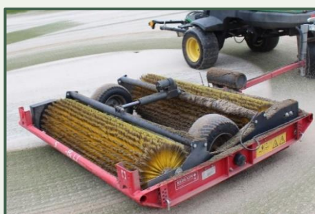
Schritt 4: Einschleppung des Sandes in die Löcher mit Hilfe einer rotierenden Spezialbürste.
