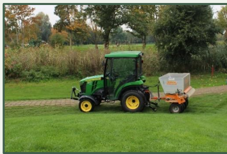
Schritt 2: Befüllung der Maschine mit feuergetrocknetem Sand der Körnung 0,3 bis 1,25.
